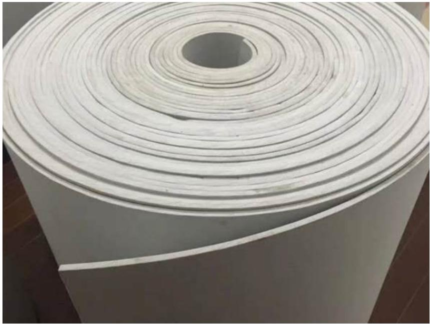
遇水膨胀橡胶止水带是什么呢？它是一种复合型的橡胶止水带；主要材料要根据止水带使用的环境和建筑的设计要求选择合适的橡胶型号。它在一般的橡胶止水带上附加了两条特殊的防水线；这种防水线的材质是一种特殊的橡胶，遇到水后会吸水膨胀，由于其体积的增大，使得止水带和混凝土构筑物结合的更紧密，水不能渗透过来。遇水膨胀橡胶止水带的主要材质遇水膨胀止水带的主要材质和一般橡胶止水带一样，是天然橡胶和特种合成橡胶，防水线是遇水膨胀橡胶，采用两种橡胶结合的工艺生产。遇水膨胀橡胶止水带的常用型号它的常用型号和普通橡胶止水带一样，宽度200-500mm，厚度6-20mm，生产执行标准是GB18173.2-2000《高分子防水材料-止水带》。遇水膨胀橡胶止水带的优点遇水膨胀橡胶止水带相对于普通橡胶止水带提供了更好的密封防水性能，它在橡胶止水带和混凝土结合不是很严密的情况下也能提供很好的止水防渗效果。止浆条是用来进行止水的。制梁台座止浆棒价格
