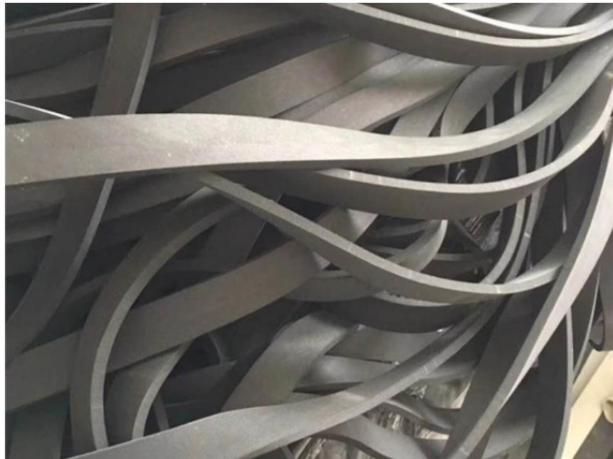
止浆条属于橡胶止浆条中的一种产品。中埋式橡胶止浆条是一种主要用于在混凝土变形缝、伸缩缝等混凝土内部设置的止浆条产品，具有以橡胶材料弹性和结构形式来适应混凝土伸缩变形的能力。本产品是利用橡胶的高弹性和压缩变形性，在各种荷载下产生弹性变形，从而起到紧固密封有效地防止建筑构件的漏水，渗水，并起到减震缓冲作用，可确保工程建筑物的使用寿命。应防止橡胶止浆条偏移，当在浇铸固定橡胶止浆条时。水带是在混凝土浇注过程中部分或全部浇埋在混凝土中。混凝土中有许多尖角的石子和锐利的钢筋头，由于塑料和橡胶撕裂强度比拉伸强度低3-5倍，止浆条一旦被刺破或撕裂时，不需很大外力裂口就会扩大，所以在止浆条定位和混凝土浇捣过程中，应注意定位方法和浇捣压力，以免止浆条被刺破。
